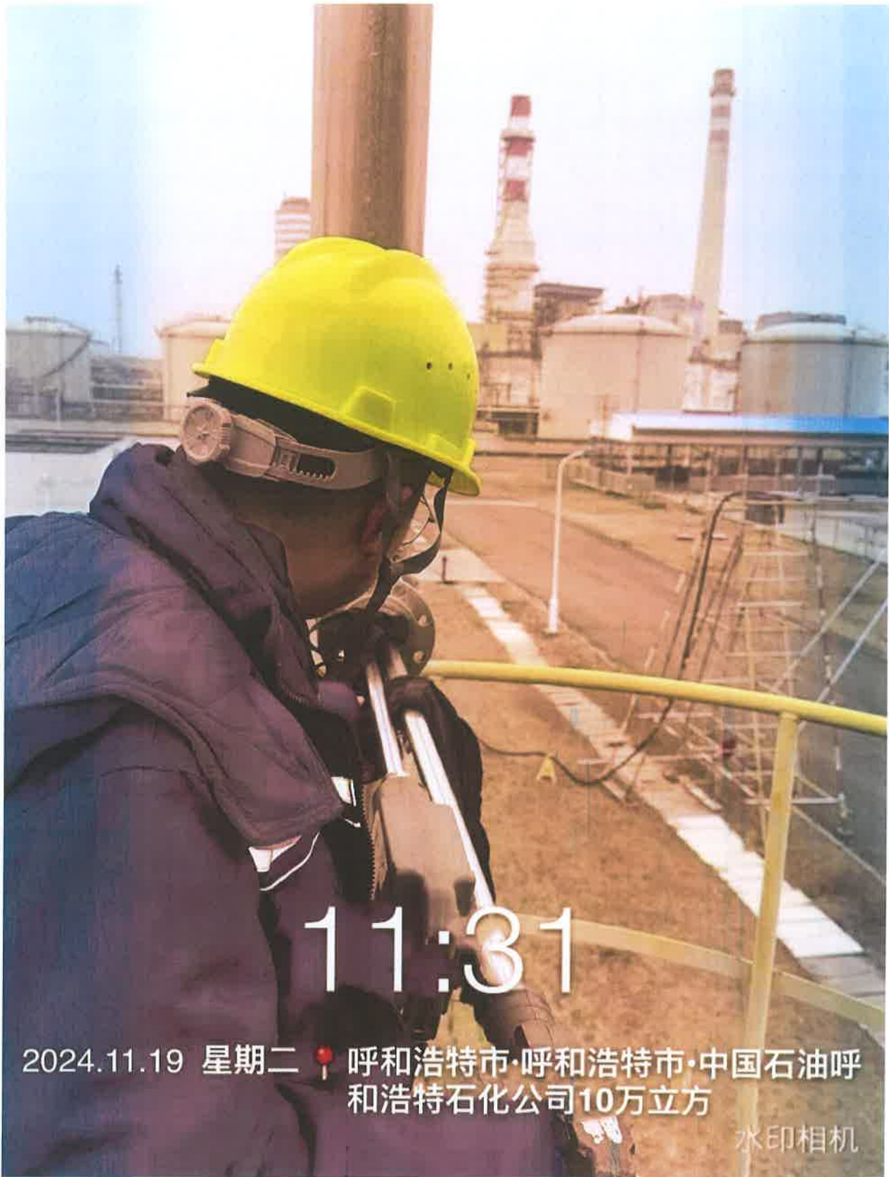
图1 10万立污水池废气处理设施排放口采样点位照片
